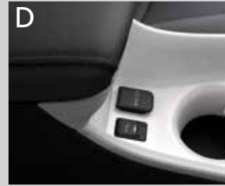
D مقبس USB/مخرج ومقبس كهرباء: يتيح مقبس USB/مخرج صوت ميني توصيل مشغل موسيقي محمول للاستمتاع بالصوت على سماعات السيارة الرائعة. كما يتيح مقبس الكهرباء شحن مختلف الأجهزة الإلكترونية. USB/mini-jack & power outlet: The USB/mini-jack enables a portable music player to be connected and enjoyed over the vehicle's speakers. A power outlet enables charging of various electric devices.
