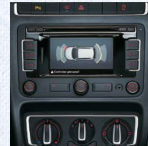
Sensor de estacionamiento delantero y trasero (Park Pilot)*.
