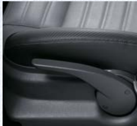
Asiento del conductor con ajuste milimétrico de altura (SIT & ADJUST).
