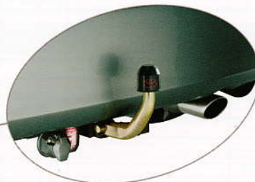
Anhängekupplung abnehmbar (auch in fixer Ausführung lieferbar), max. Anhängelast 1600 kg, Stützlast max. 65 kg
