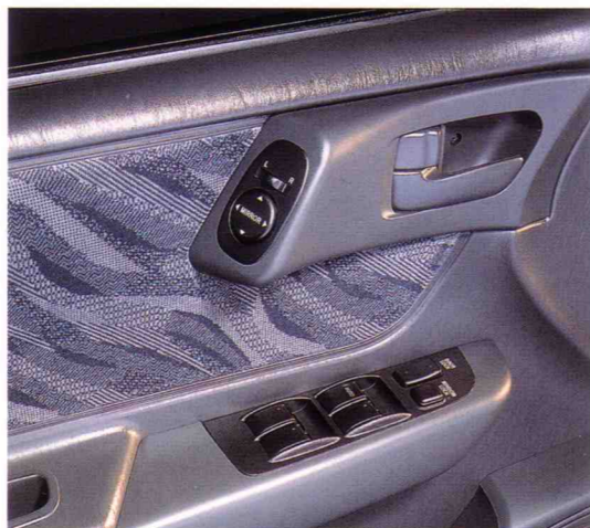
2 Der Fahrer kontrolliert die elektrischen Fensterheber, die Zentralverriegelung und die Außenspiegel-Einstellung über eine Schalterkonsole, die in die Türverkleidung integriert ist – und somit bequem mit einer Hand erreichbar ist (GL-Modelle).
