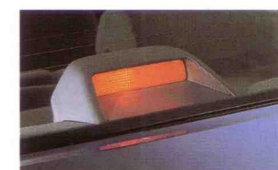
6 Die 3. Bremsleuchte im Heckfenster kündigt Ihr Bremsmanöver deutlicher an – und reduziert die Gefahr von Auffahrunfällen.
