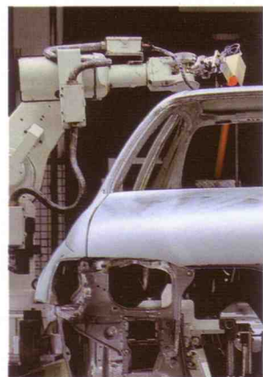
1 Die Karosserie des Carina wird auf einer der modernsten Produktionsstraßen der Welt gefertigt. Mit Laser wird sie auf Präzision geprüft – bis auf 0,1 mm genau.
