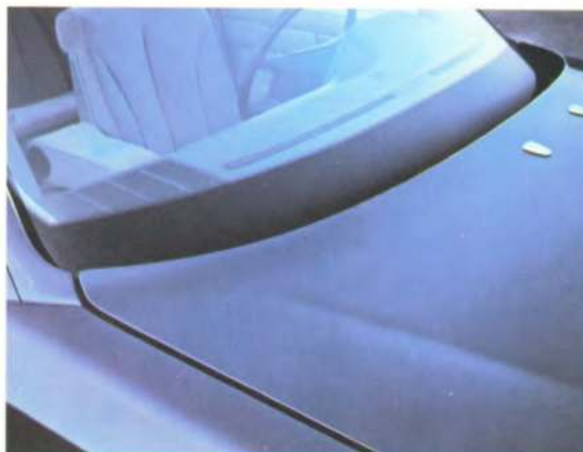
Verzonken gemonteerde ruitwissers verminderen de kans op letsel bij ongelukken met personen.
