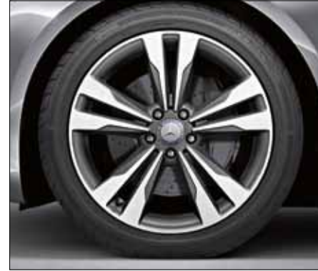
Leichtmetallrad im 5-Doppelspeichen-Design, himalaya-grau lackiert und glanzgedreht, mit Bereifung 245/45 R 19 vorn und 275/40 R 19 hinten (Code R17).
