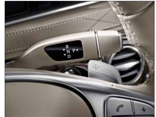
DIRECT SELECT Wählhebel am Lenkrad. Per zusätzlichen Schaltwippen kann der Fahrer auch manuell hoch- oder runterschalten.
