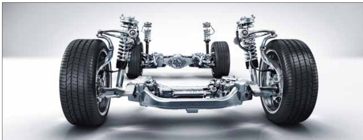
Das volltragende semiaktive Luftfederungssystem AIRMATIC mit stufenloser Dämpfungsregelung vereint hohen Federungs- und Abrollkomfort mit exzellenter Fahrdynamik.
