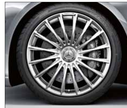
AMG Schmiederad im Vielspeichen-Design, keramisch hochglanzpoliert, mit Bereifung 255/40 R 20 vorn und 285/35 R 20 hinten (Code 696).
