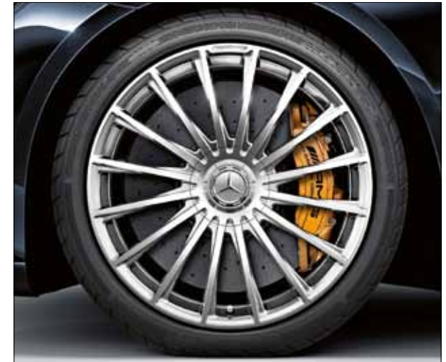
Das serienmäßige AMG Schmiederad in 20 Zoll im Vielspeichen-Design mit optionaler AMG Keramik Hochleistungs-Verbundbremsanlage.
