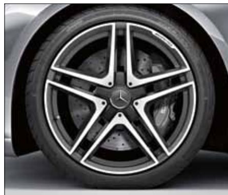
AMG Schmiederad im 5-Doppelspeichen-Design, titangrau lackiert und poliert, mit Bereifung 255/40 R 20 vorn und 285/35 R 20 hinten (Code 753).
