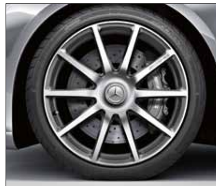
AMG Schmiederad im 10-Speichen-Design, titangrau lackiert und poliert, mit Bereifung 255/40 R 20 vorn und 285/35 R 20 hinten (Code 647).
