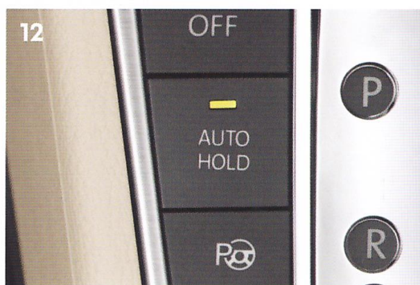
12. Freio eletrônico de estacionamento com sistema Auto-Hold - para trânsito intenso, subidas e descidas.
