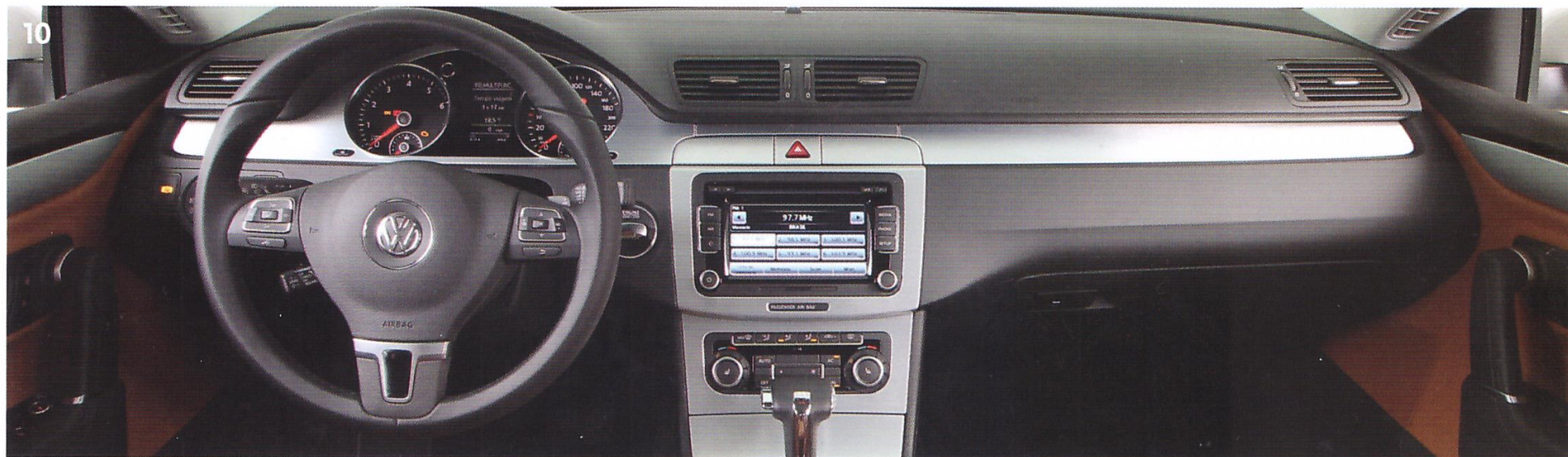
10. Rádio RCD 510 com touch screen, ar-condicionado Climatronic Dual Zone e acionamento do Tiptronic no volante.
