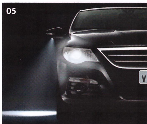
05. Faróis bi-xenon direcionais com lavador, regulação automática de fecho, acionamento automático (ALS) e função coming/leaving home.
