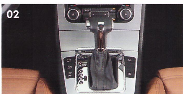
02. Transmissão automatizada de dupla embreagem DSG Tiptronic de 6 velocidades.
