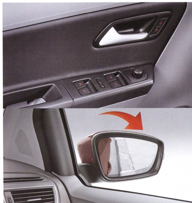
Espelhos retrovisores externos eletricamente ajustáveis com função Tilt down no lado do passageiro
