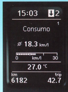
Econômetro e indicador de troca de marcha.
