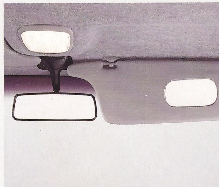
Iluminação central interna temporizada.
