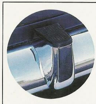
Marchepied à la partie supérieure du pare-choc arrière.
