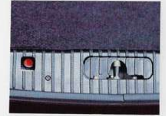
Bei allen Scorpio wird bei einer Kollision die Benzinzufuhr durch einen Trägheitsschalter automatisch unterbrochen.
