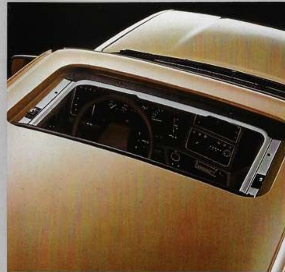
Glas-Schiebe- und Hubdach mit verschiebbarer Sonnenblende (serienmässig beim Sierra Ghia)
