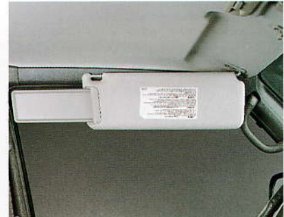
Drehbare Sonnenblende mit Verlängerung. Pare-soleil pivotant avec rallonge. Aletta parasole orientabile, con prolunga.
