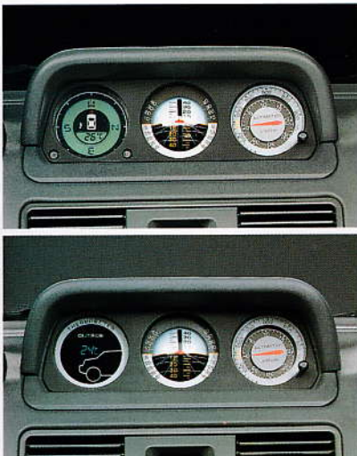
Multi-Meter Konsole (GLS) mit Neigungs-/Höhenmesser und Aussenthermometer (einige Modelle: zusätzlich Kompass)
