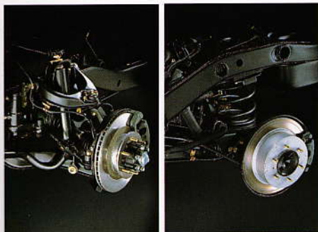
Einzelradaufhängung vorn. Schraubenfedern hinten. Suspension avant avec roues indépendantes. Ressorts hélicoïdaux à l'arrière. Sospensioni anteriori a ruote indipendenti. Molle elicoidali posteriori.
