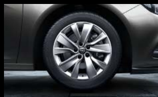
RQH: Jante en alliage léger 7½ J x 18, 5 branches doubles, pneu 235/50 R18. Option.
