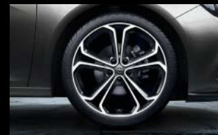
RQA: Jante en alliage léger 8½ J x 20, 5 branches doubles, BiColor, pneu 245/40 R20. Option.
