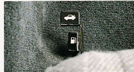
Tankdeckel- und Kofferraumentriegelung vom Fahrersitz aus Déverrouillage de la trappe de réservoir et du hayon depuis le siège de conduite Sbloccaggio del portellone e del serbatoio dal posto di guida
