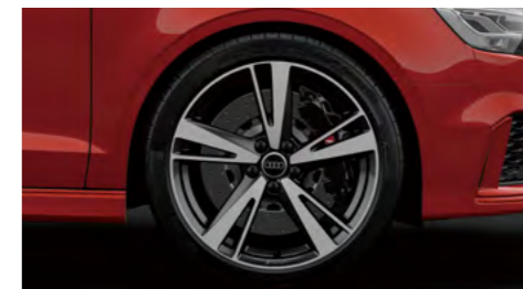
选装 19英寸铸铝车轮,5辐刀锋设计,黑色高光 尺寸一:8.5J x 19,轮胎255/30 尺寸二:8J x 19,轮胎235/35
