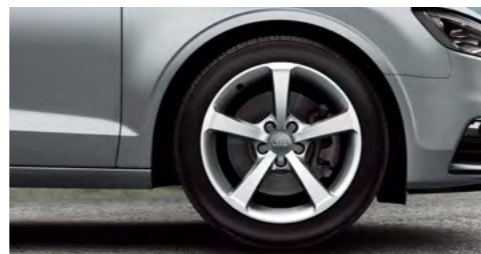
17英寸铸造铝合金车轮,5辐星型设计,尺寸:7.5Jx17 轮胎:225/45 R 17 *仅供A3 Cabriolet
