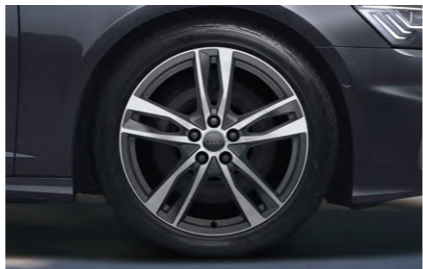
5双辐19英寸铝合金轮辋, 对比灰色, 部分抛光 尺寸:8.5J×19 轮胎:245/45 R19 102Y
