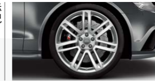
20英寸铸造铝合金轮毂 七辐双臂设计, 抛光 尺寸9.5J x 20, 轮胎275/35
