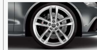
21英寸铸造铝合金轮毂 五双辐设计, 抛光 尺寸9.5J x 21, 轮胎285/30
