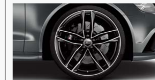
21英寸铸造铝合金轮毂 五双辐设计, 黑色高光, 抛光 尺寸9.5J x 21, 轮胎285/30
