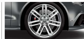
20英寸铸铝车轮 7辐双臂设计,抛光 尺寸9J x 20,轮胎275/35 R20
