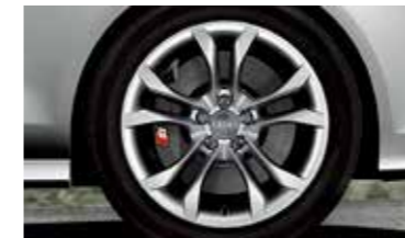
5辐双臂S车型专享造型铸铝车轮 尺寸: 8.5J×19, 轮胎: 255/40 R19 (Audi S7标配)
