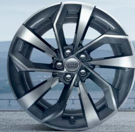
19 英寸 5 双辐铝合金轮辋， 灰色，部分抛光 尺寸：8.0Jx19 轮胎：235/55 R19
