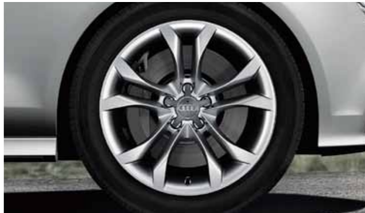
5双辐S风格20英寸铸铝车轮 尺寸：8.5Jx20 轮胎：255 / 45 R20
