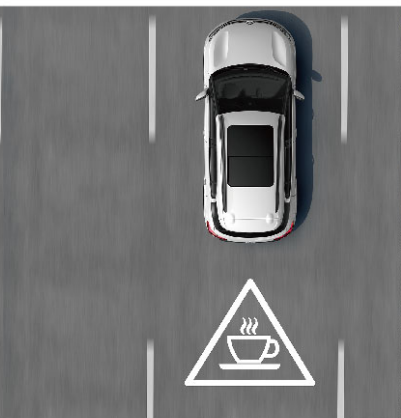
驾驶员疲劳驾驶提醒功能 当达到驾驶疲劳时长后,周期性持续提醒驾驶员休息。
