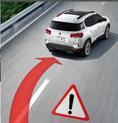
LKA 车道保持辅助系统 车速大于60Km/h时,实时监测前方路面车道,当驾驶员无意识越线,智能预警,车速大于70Km/h时,系统将自动修正航道。
