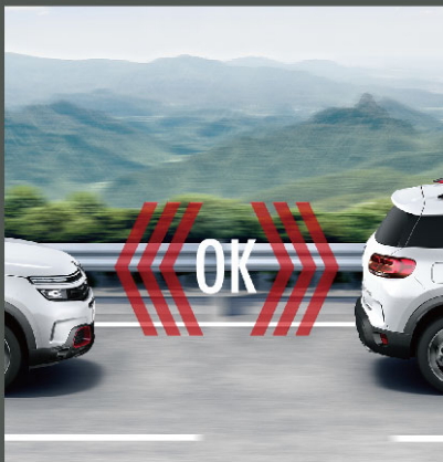
ACC-STOP 带自动刹车功能的自适应巡航 根据设定的巡航速度和前车距离,智能调节车速,自动跟车,并能跟随前车至停止。
