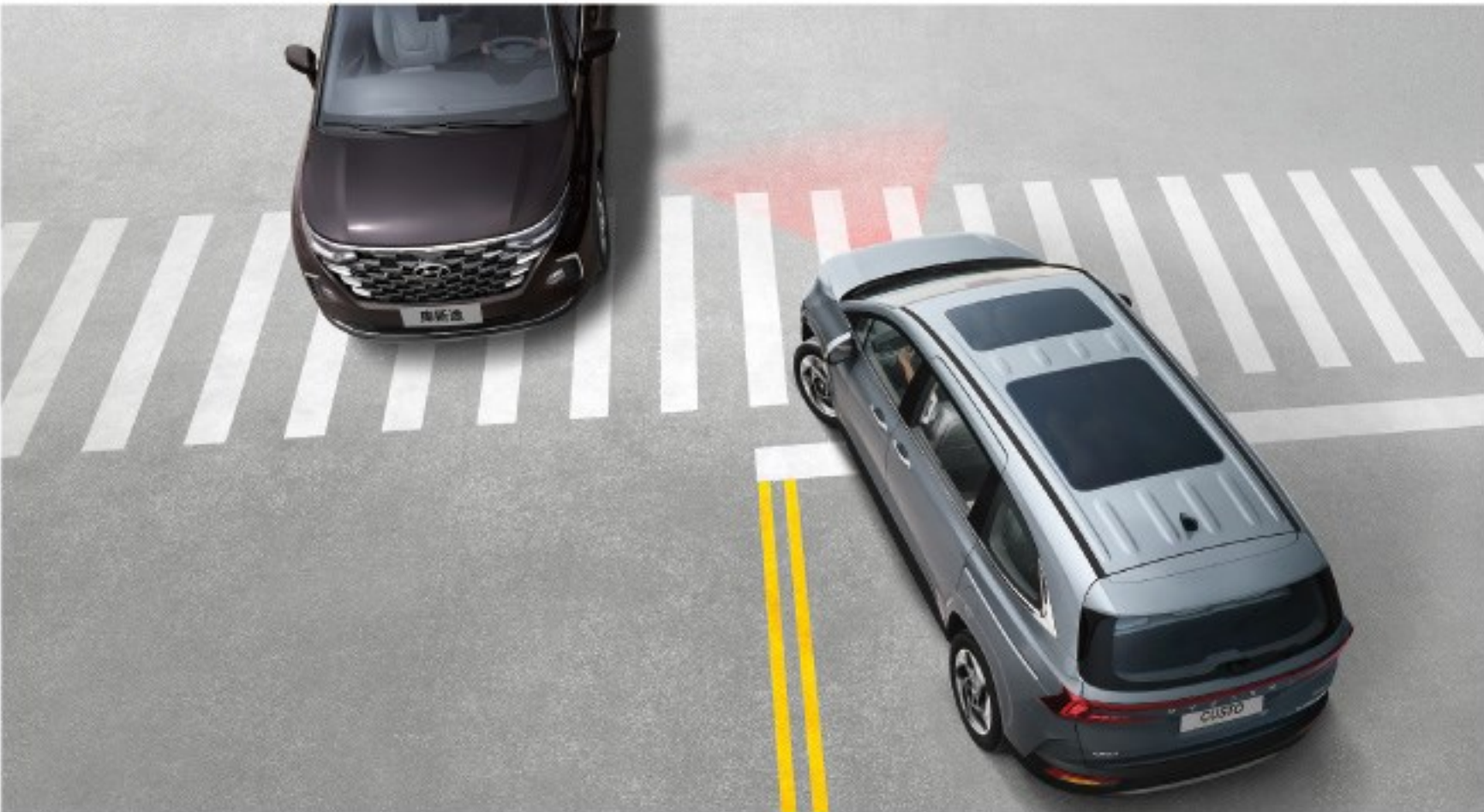
• FCA-JT 前方防碰撞辅助-交叉路对向车 侦测前方车辆、行人、两轮车及交叉路口对向直行车辆，预先警告并采取制动措施，有效避免碰撞事故的发生，保证行人及驾乘安全
