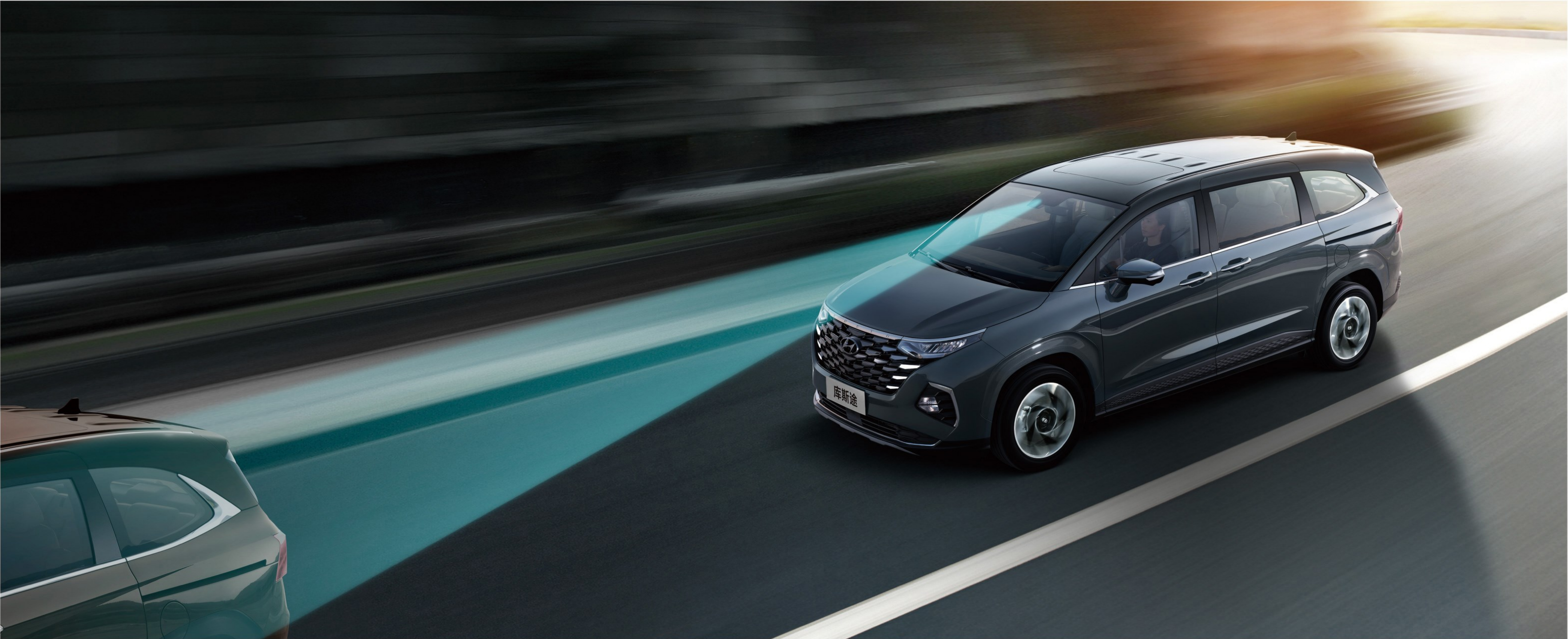
• NSCC 基于导航智能巡航控制 根据高速路段调整车速，自动识别前方弯道并减速，确保安全性/便利性
