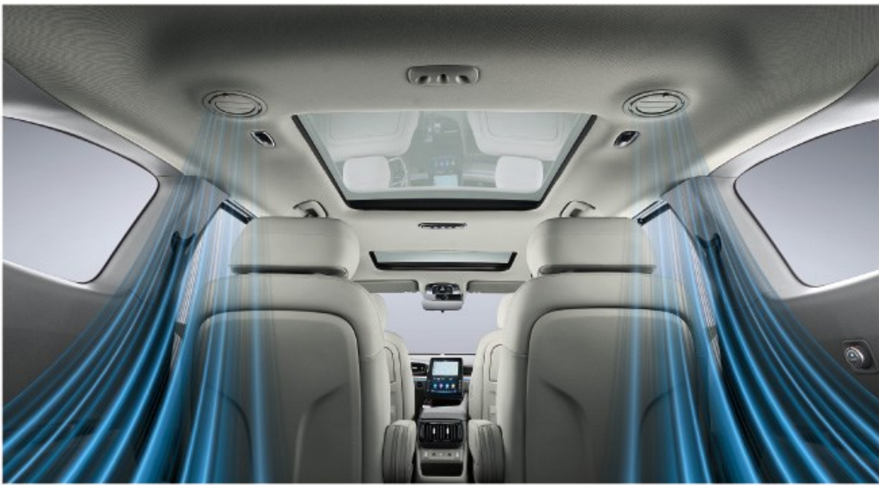
• 无感式柔风空调 同级独有的第三排无感式空调出风口可为第三排乘客提供无风感式柔风，防止出现因空调直吹引起老人、儿童不适
