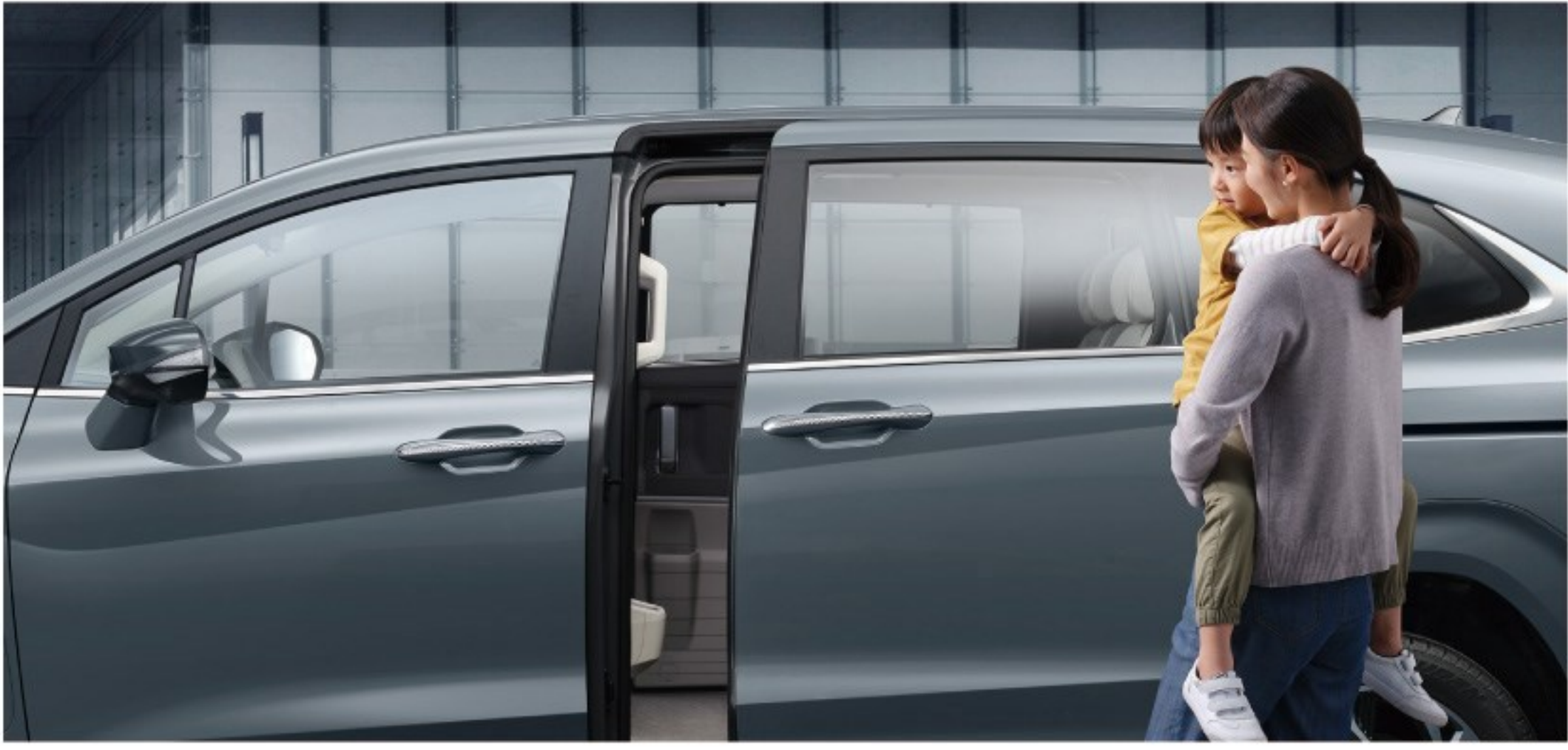
• 智慧电动侧滑门 双侧智能电动门，在不便手动操作解锁时，携带钥匙靠近车辆即可被识别，自动打开电动侧滑门
