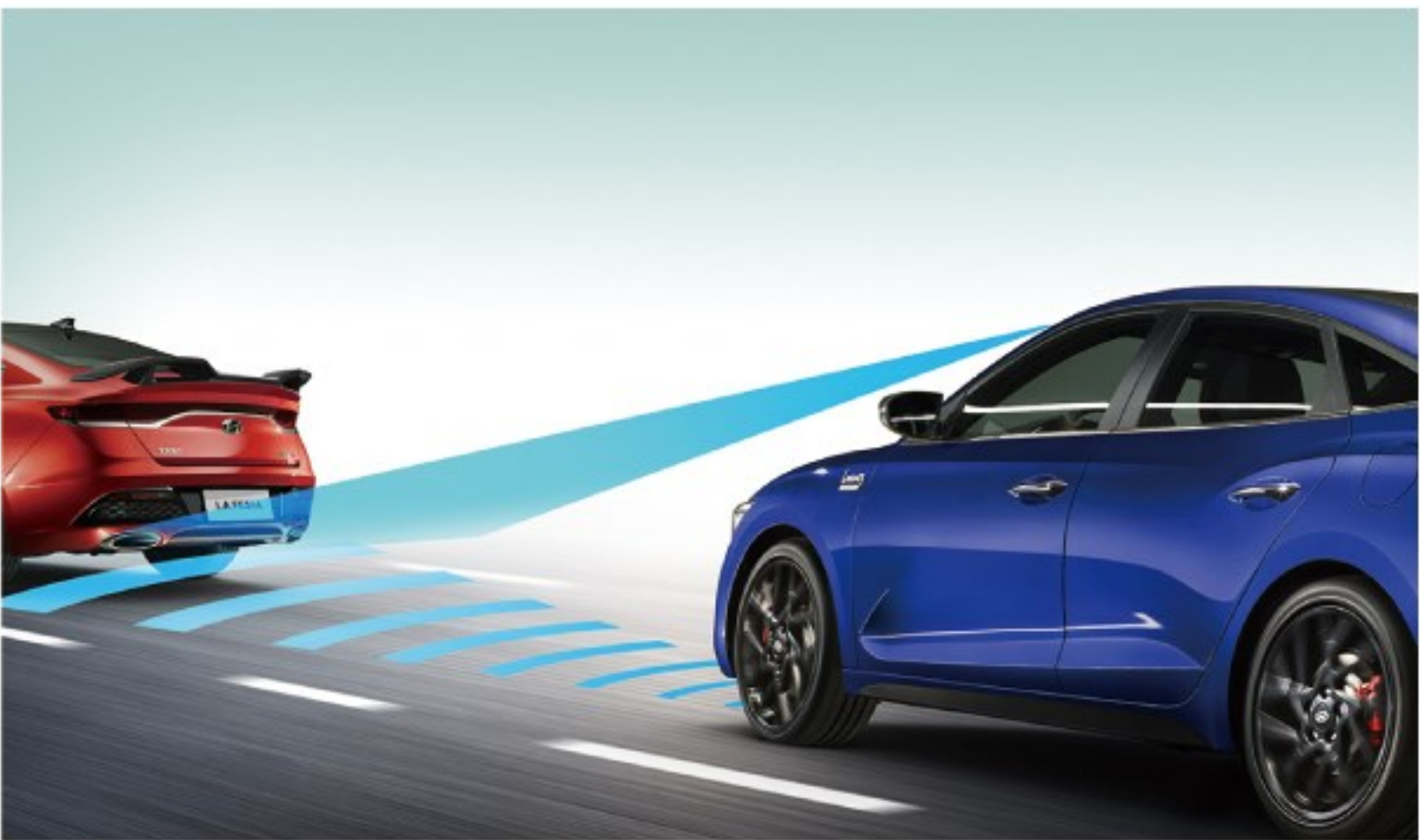
• FCA 前方防碰撞辅助 侦测前方车辆及行人，预先警告并采取制动措施，有效避免碰撞事故发生
