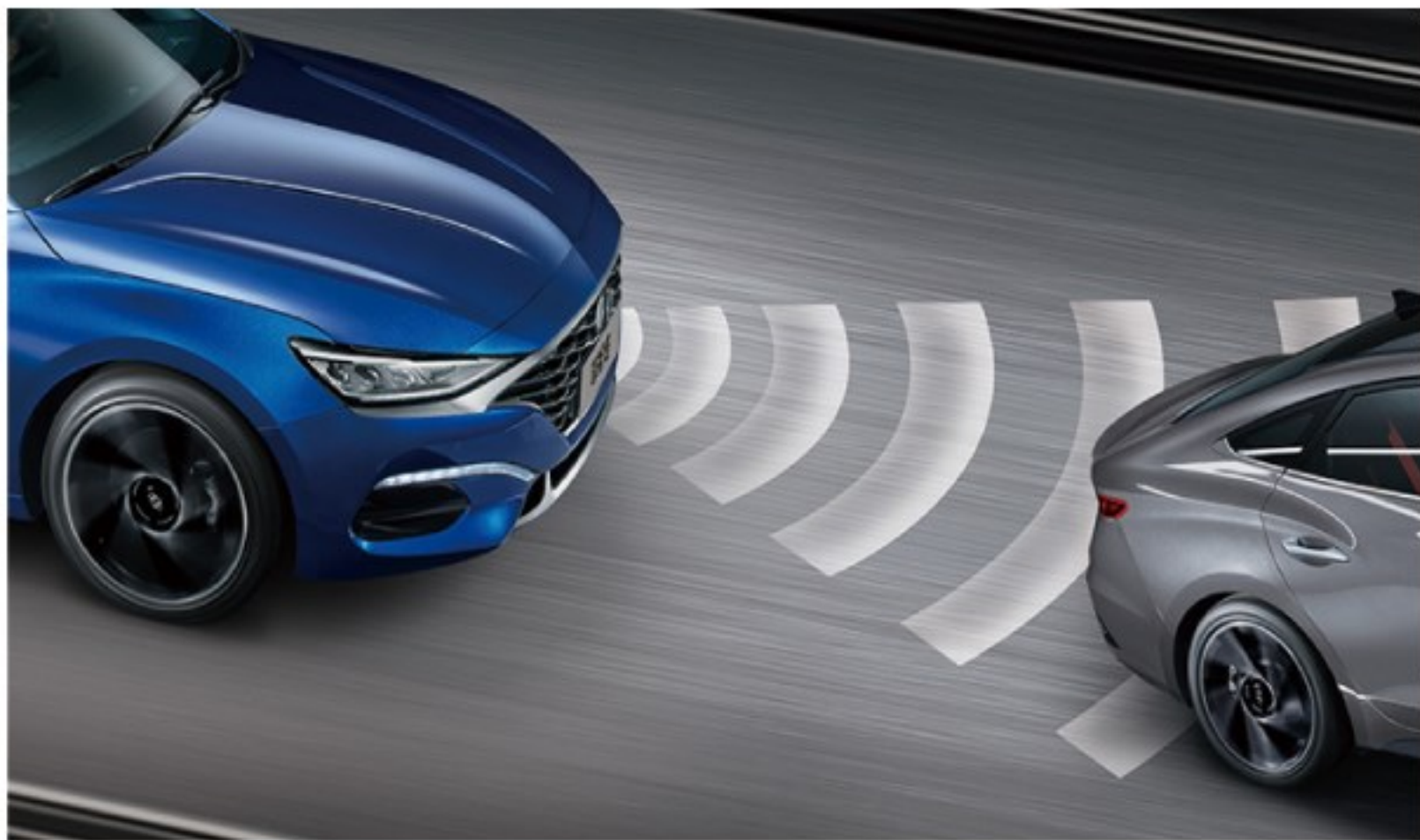
• SCC 智能巡航控制(带停走功能) 监测与前方车辆的距离和车速以保持车距，并进行加速、减速、停车操作
