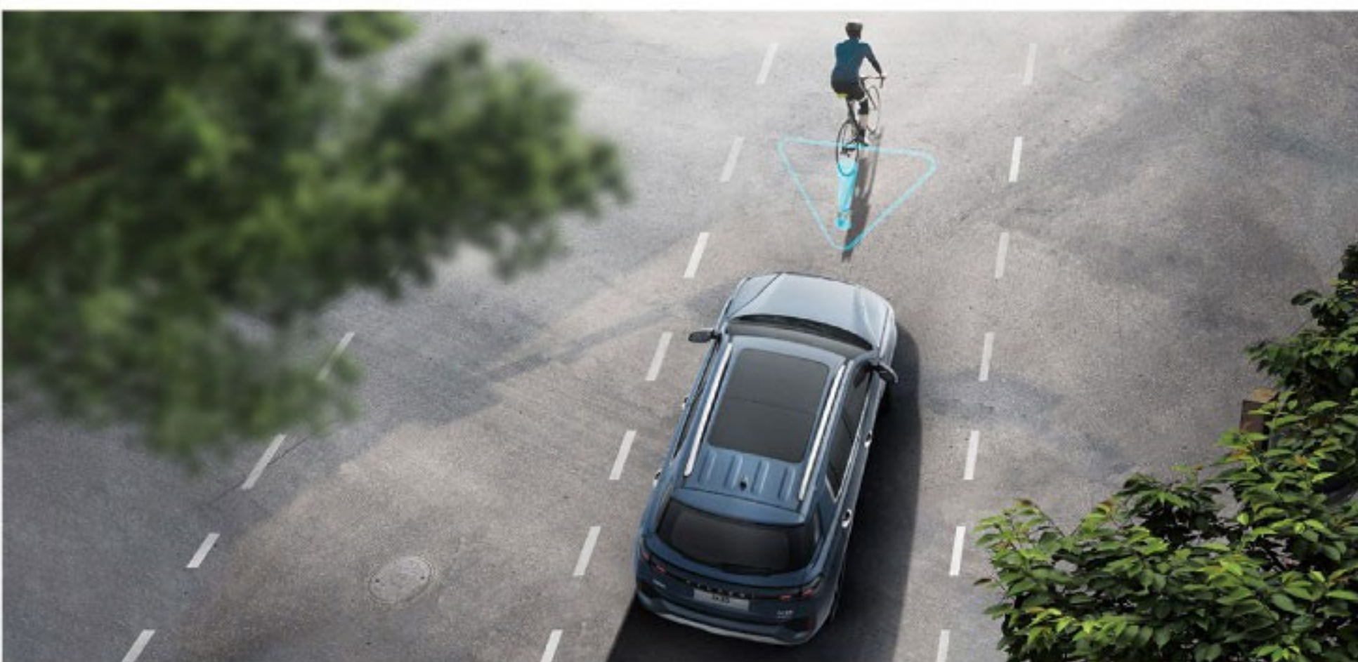
• FCA-F 前方防碰撞辅助 识别到与前方车辆/行人/自行车骑行者有碰撞危险，并警报后依旧有碰撞危险时自动进行制动
