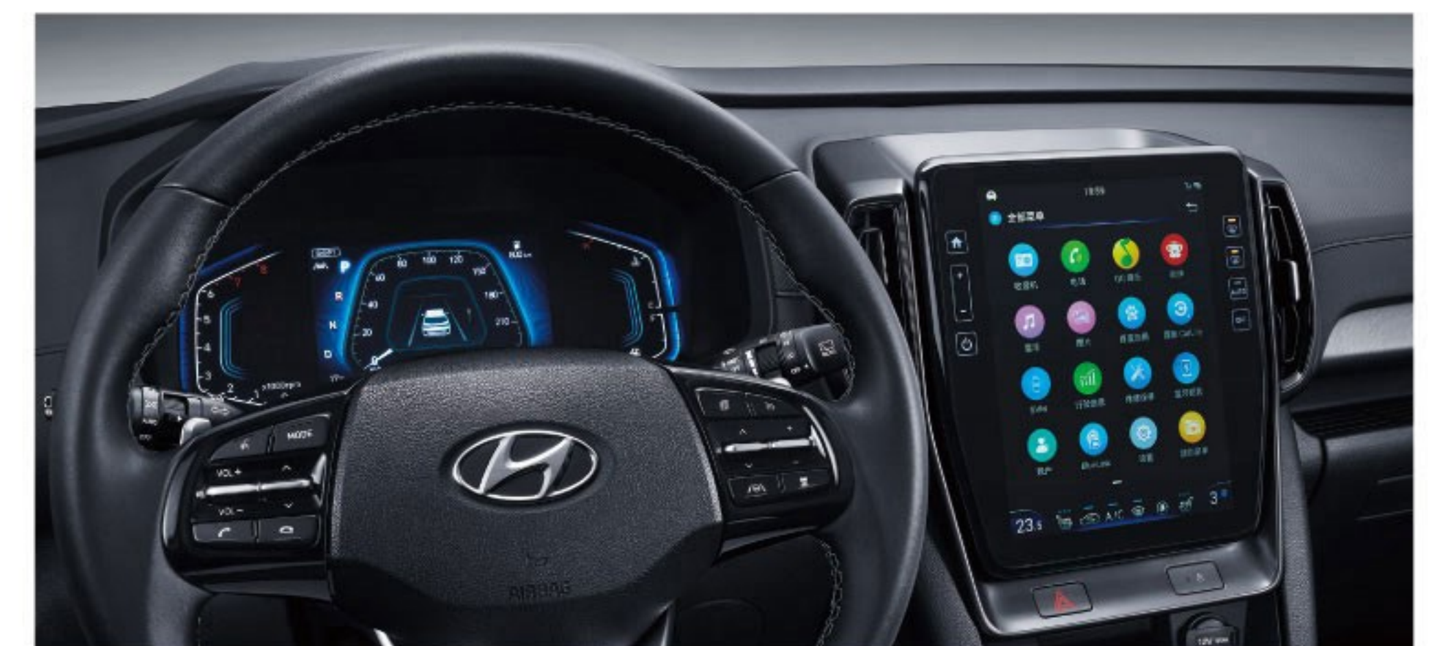
• 10.4英寸全触控高清智慧大屏和7英寸彩色液晶仪表盘
