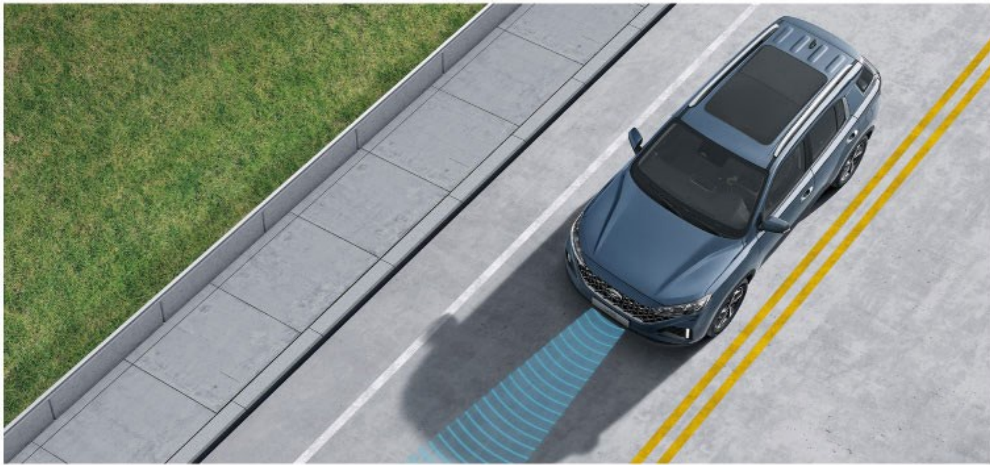
• LFA 车道居中保持 用前置摄像头探测车道和车辆，辅助保持在车道中央行驶，提高驾驶便利性
