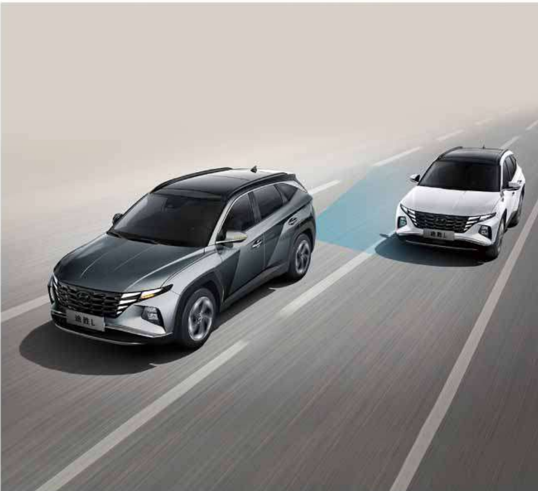
• BCA 盲区防撞辅助 监测后侧方临近车辆，发现有碰撞危险时，系统采取警告和制动，避免或减轻碰撞伤害
