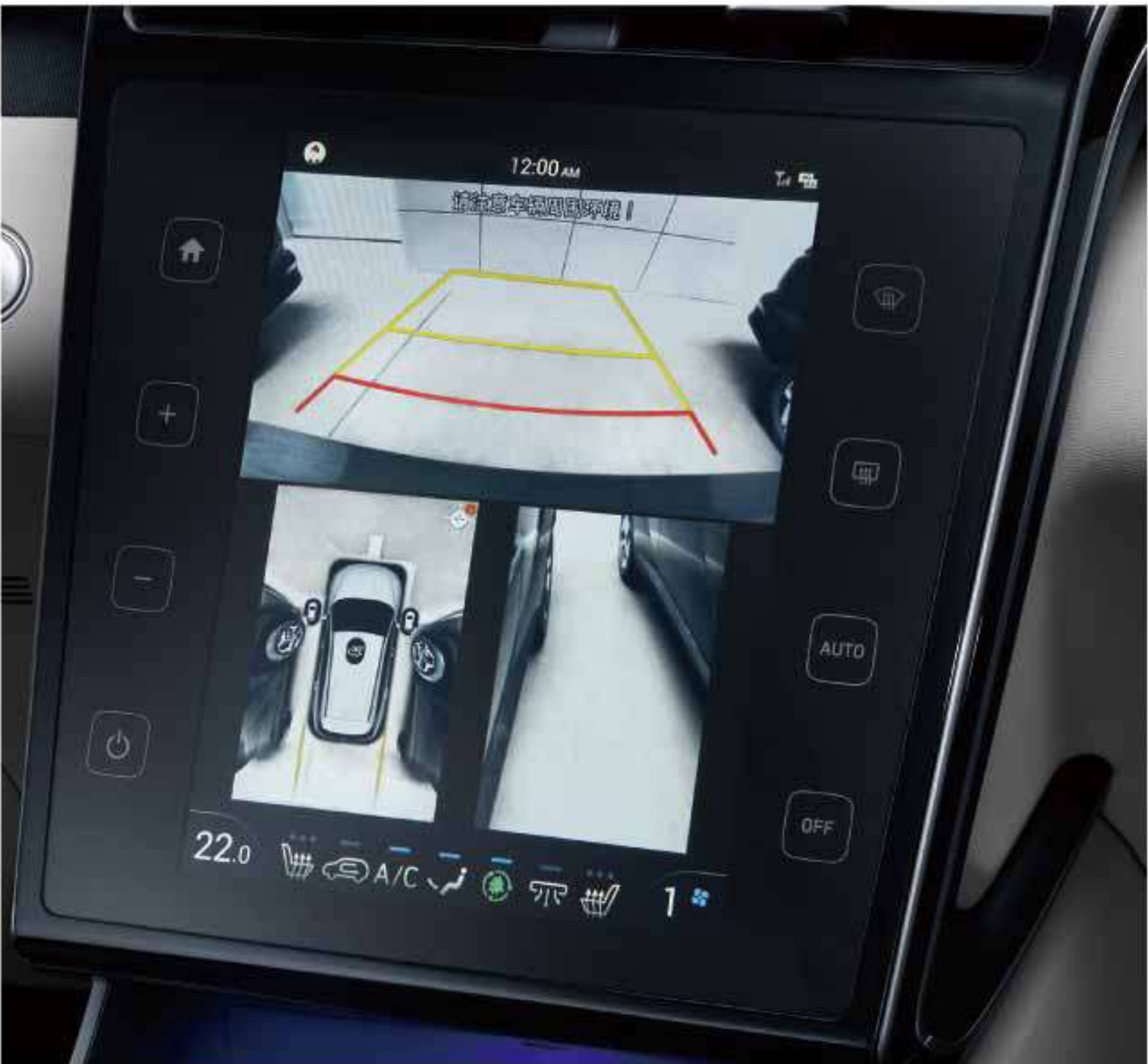
• SVM 360°全景影像 行车时通过中控按键切换不同区域的影像，倒车时可显示360度全景摄像，增强泊车时的安全性和便利性
