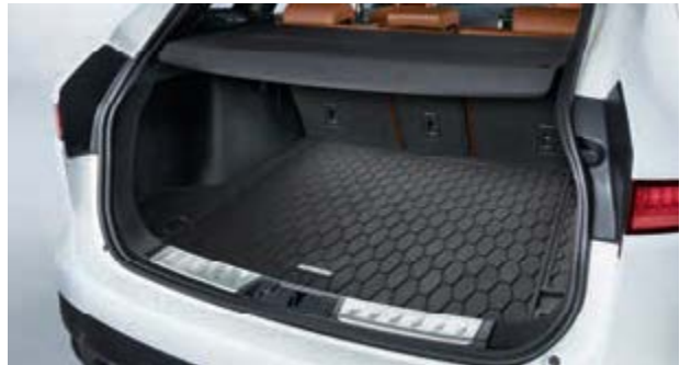
行李箱橡胶垫* T4A4218 此高级橡胶垫专为保护行李箱量身定制。它重量轻且耐用，易于拆除进行清洁。
