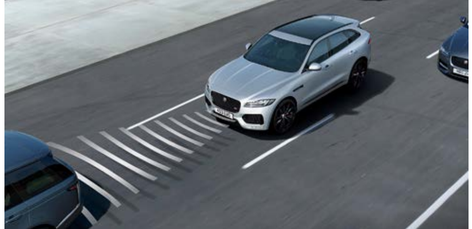
自适应定速巡航系统，集成排队辅助功能
