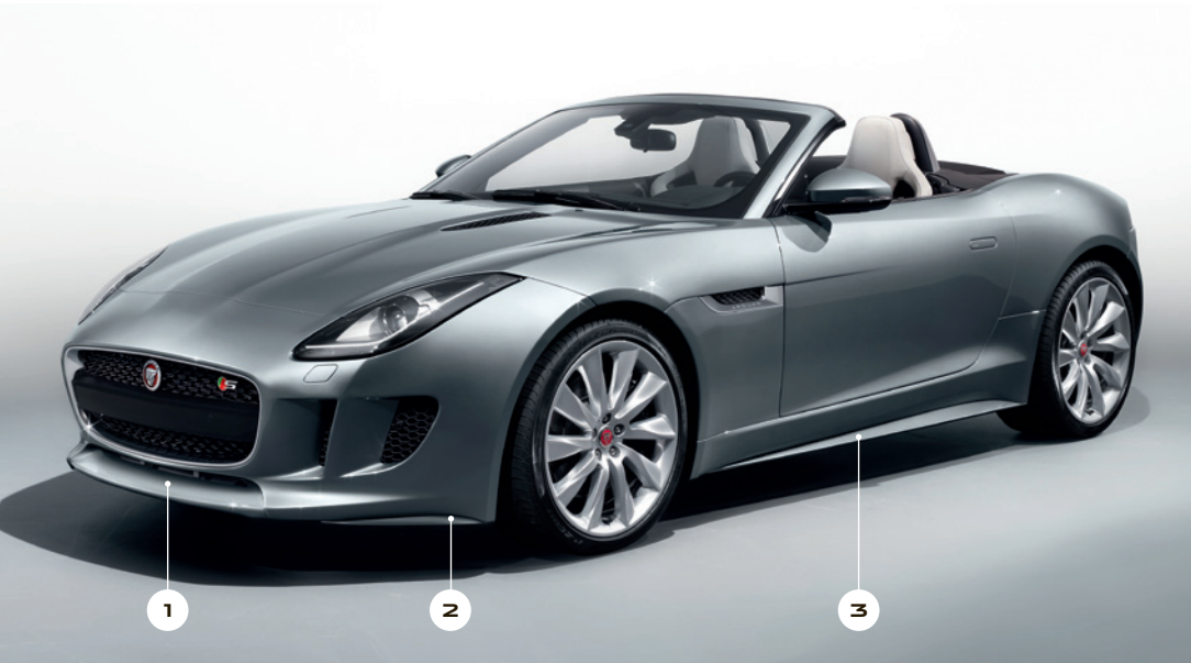
设计套件* 1. 车身同色前保险杠分流板 2. 车身同色空气动力分流板 3. 车身同色加长侧裙边 4. 亮黑色后保险杠下部饰板 5. 车身同色后保险杠喉管
