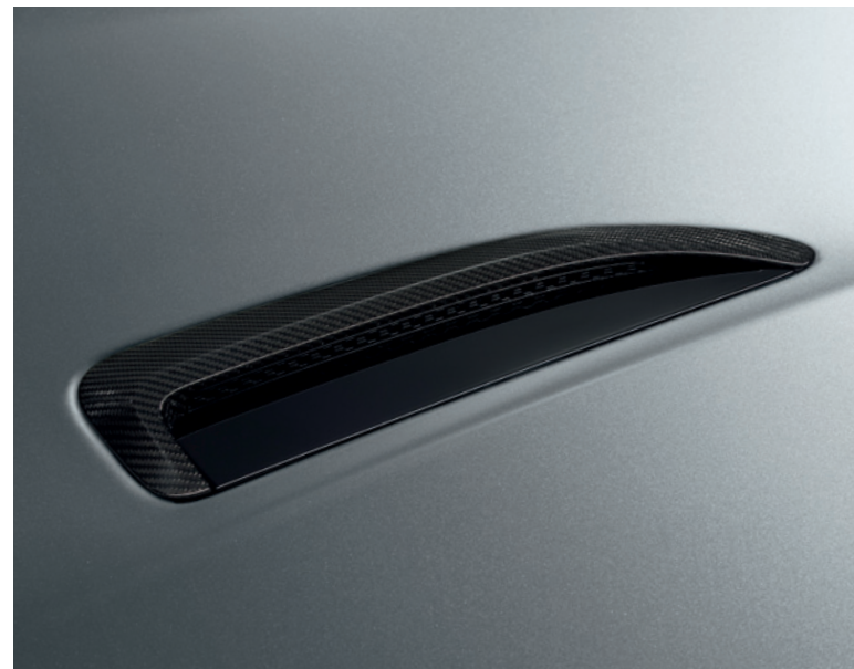
碳纤维发动机罩通风百叶窗 高级碳纤维发动机罩百叶窗突出了 F-TYPE 最显著的特征之一。
