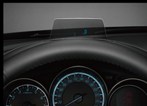
Active Driving Display 高级平视显示系统 集成车速、导航、定速巡航等信息，通过平视化显示，减少驾驶员驾驶疲劳，提高行车安全。
