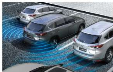
[ 倒车有车辆接近时发出通知 ] RCTA 倒车预警系统 车辆倒车时,通过车身后部的雷达传感器,监测后方两侧盲区内的接近车辆和障碍物,后视镜上指示灯会发出闪烁信号以及警示音,以此提醒驾驶员,有效降低盲区风险,倒车从此从容。
