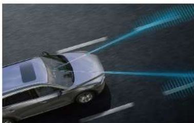
[ 车道偏离警告 ] LDWS 车道偏离警示系统 通过搭载在前挡风玻璃上的前摄像头,对路面标识线进行识别。当车辆偏离车道时,向驾驶员发出警示音,提示驾驶员尽快做出正确操作。
