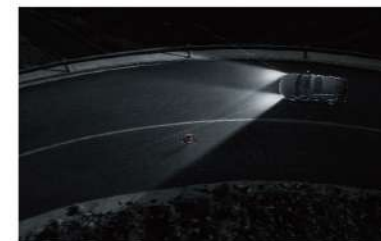
[ 确保夜间安全驾驶的可视性 ] AFS 前大灯智能弯道辅助照明系统 依据行驶状态来控制实现前大灯的优越布光,感知车速与方向盘转角,向行驶方向照射前大灯光束,带来更宽广的夜间视野。
