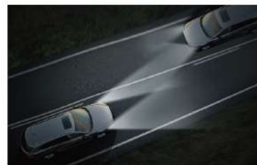
[ 确保夜间安全驾驶的可视性 ] HBC 自适应远光灯控制系统 通过搭载在前挡风玻璃上的前摄像头,探测到前方或对向行驶车辆,会在远光灯和近光灯之间自动切换,在夜间行驶时确保驾驶员清晰视野。
