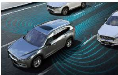
[ 有其他车辆从盲区接近时发出通知 ] BSM 盲点监测系统 在正常行驶以及变道行驶时,位于车身后部的雷达传感器,会监测到后方两侧盲区内的接近车辆,后视镜镜面指示灯会闪烁并向驾驶员发出警报,有助于规避行车风险,让驾乘更安全。
