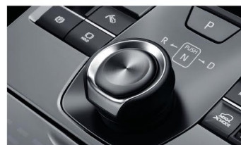
旋钮式电子换挡
