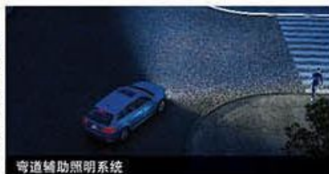
弯道辅助照明系统
