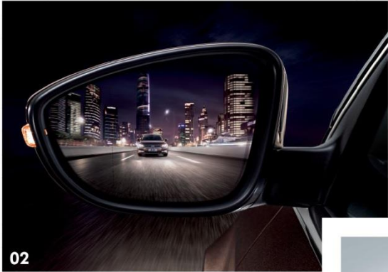
02 驾驶员侧自动防炫后视镜 通过传感器实时监测，根据后方灯光强度自动调整镜面反射效果，保证稳定及良好的前方视野，提高夜间行车安全。同时，如果邻近车退出视野其它车辆，车外后视镜可探测到其当前位置、行驶速度以及方向，当别的车辆出现在死角盲区或者快速靠近本车，后视镜上则会亮起警示信号灯，提醒驾驶员转向会有危险。
