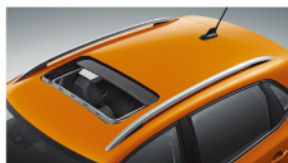
双层防夹电动天窗+炫银车顶行李架
