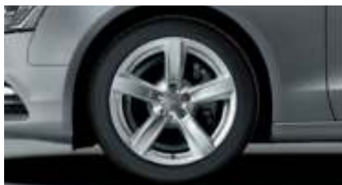
Kola hliníková litá, v 5ramenném designu Dynamik velikost 8,5 J x 18 s pneumatikami 245/40 R 18 1
