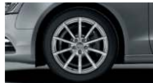
Kola Audi exclusive hliníková litá, v 10paprskovém designu velikost 8,5 J x 18 s pneumatikami 245/40 R 18 1 . Nabídka quattro GmbH
