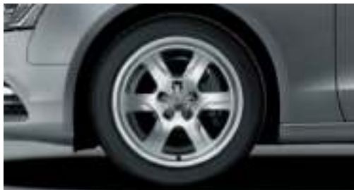
Kola hliníková kovaná, v 6ramenném designu velikost 7,5 J x 17 s pneumatikami 225/50 R 17 1
