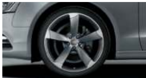
Kola Audi exclusive hliníková litá, v 5ramenném designu Rotor, s matným titanovým vzhledem, leštěná velikost 9 J x 19 s pneumatikami 255/35 R 19 1 . Nabídka quattro GmbH
