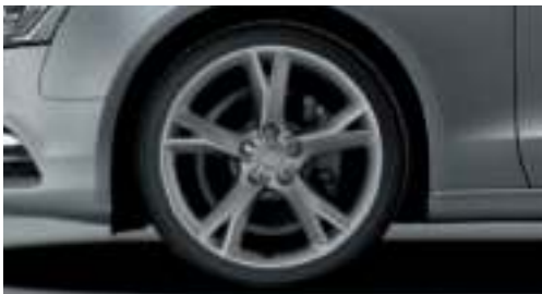
Hliníková kola v 5ramenném Y-designu, galvanicky šedá metalíza, matná 2 velikost 8,5 J x 19 s pneumatikami 255/35 R 19 1
