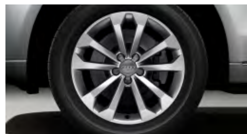
Kola hliníková litá, v 5paprskovém V-designu velikost 8 J x 18 s pneumatikami 235/60 R 18 1
