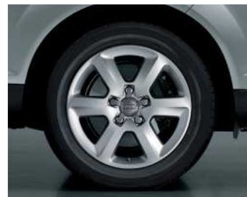
Kola hliníková litá, v 6ramenném designu velikost 8 J x 18 s pneumatikami 255/55 R 18 (sériově pro Q7 4.2 TDI quattro a Q7 3.0 TFSI quattro [245 kW])
