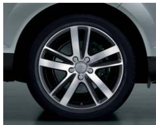
Kola hliníková litá, v 10paprskovém V-designu antracitová, částečně leštěná, velikost 9 J x 20 s pneumatikami 275/45 R 20
