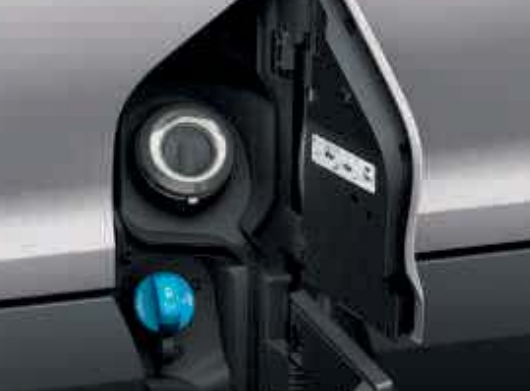
Bezzátkový systém doplňování paliva Ford Easy Fuel
