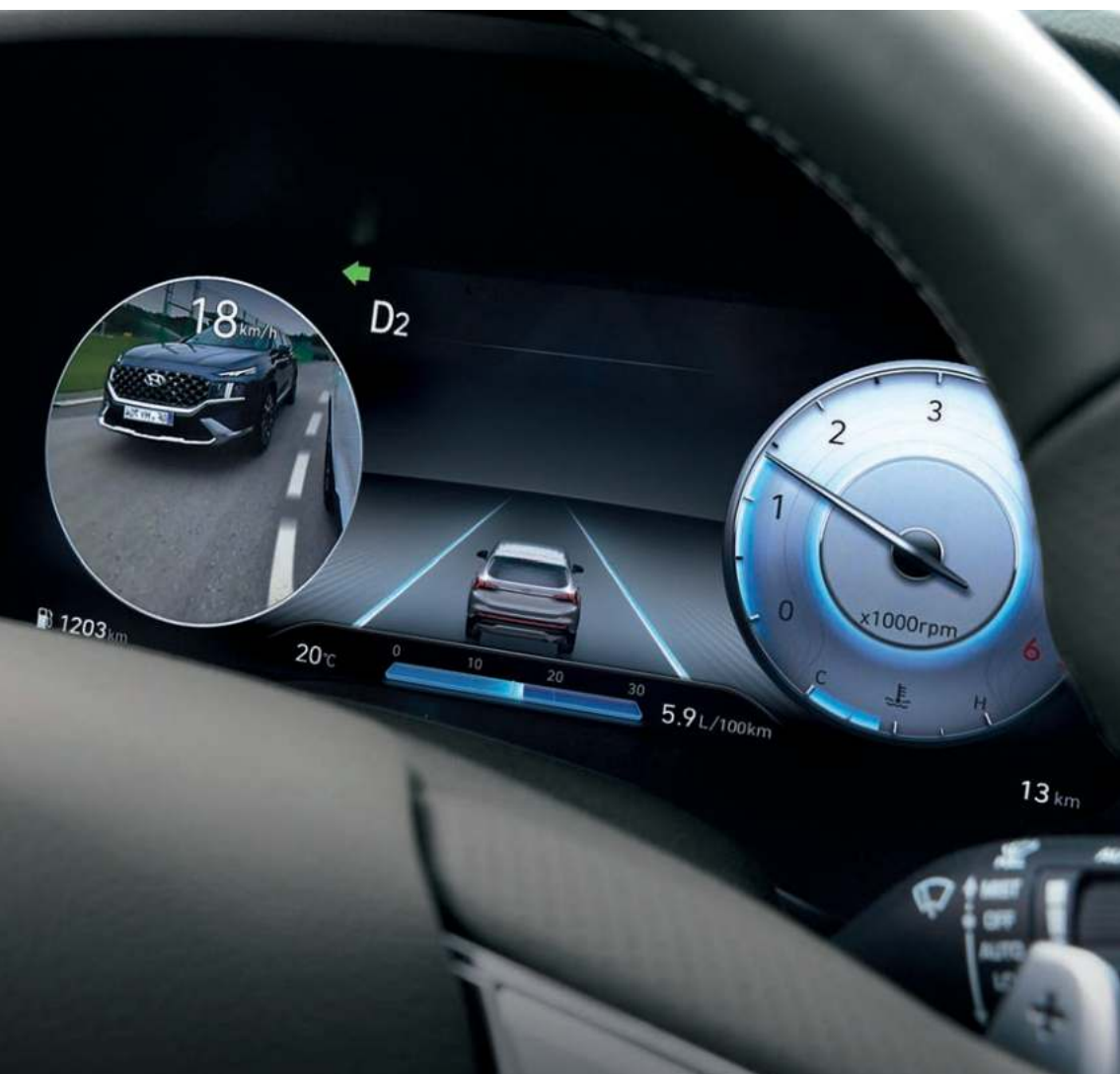
Plně digitální přístrojový panel o velikosti 12,3" a kamerovým sledováním mrtvého úhlu
