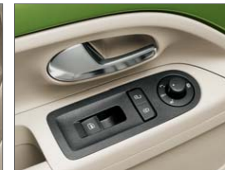
V závislosti na výbavě vozu může mít řidič po ruce ve svých dveřích hned několik ovladačů : elektrické ovládání okna řidiče, ovládání centrálního zamykání z interiéru vozu, elektrické ovládání a vyhřívání vnějších zpětných zrcátek.
