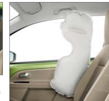
Vedle airbagů řidiče a spolujezdce představují standardní výbavu vozu speciální boční airbagy Head-Thorax , které dokážou v případě bočního nárazu ochránit hlavu i trup pasažerů na předních sedadlech.
