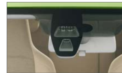
Novinkou pro bezpečnější jízdu především v plných městských ulicích je unikátní systém City Safe Drive s funkcí nouzového brzdění a senzorem CV (Closing Velocity), který sleduje prostor před vozidlem na vzdálenost 10 m a při rychlosti do 30 km/h. V případě, že řidič včas nereaguje na překážku, může systém zabránit kolizi.
