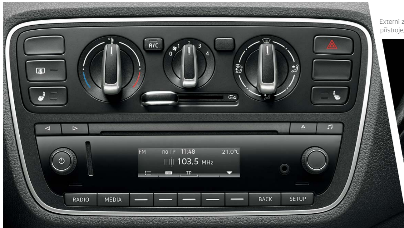
Rádio Blues s monochromatickým displejem nabízí vstup Aux-in, slot na SD karty, CD přehrávač a dva reproduktory.
