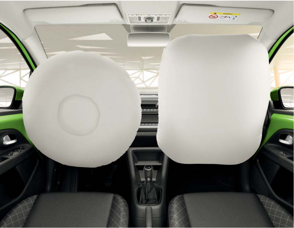
PŘEDNÍ AIRBAGY Velkoobjemové airbagy řidiče a spolujezdce se aktivují v součinnosti s přitahovači předních bezpečnostních pásů, které Vás přímo „ukotví“ na správné místo uprostřed sedadla.
