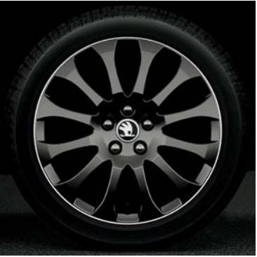
Kola z lehké slitiny Comet 6,5J x 16" (pneu 205/45 R16), v černém provedení, exkluzivně pro verzi Monte Carlo
