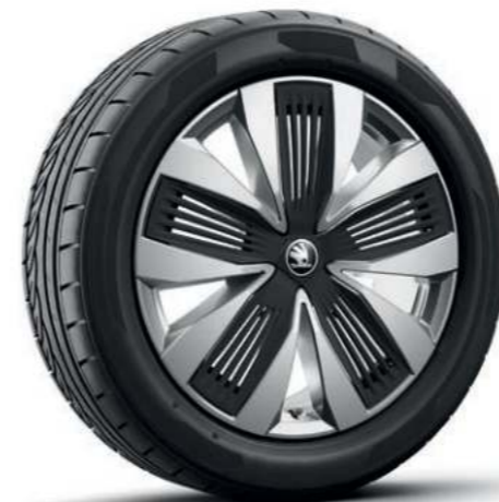
19" kola z lehké slitiny Talgar s aero kryty Disk: 7,5J × 19" ET40 Pneu: 235/50 R19
