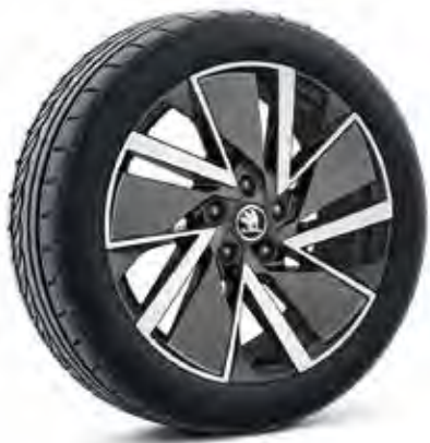
Kola z lehké slitiny VEGA Aero, 18", černá (disk: 7,5J × 18" ET48, pneu: 225/45 R18)
