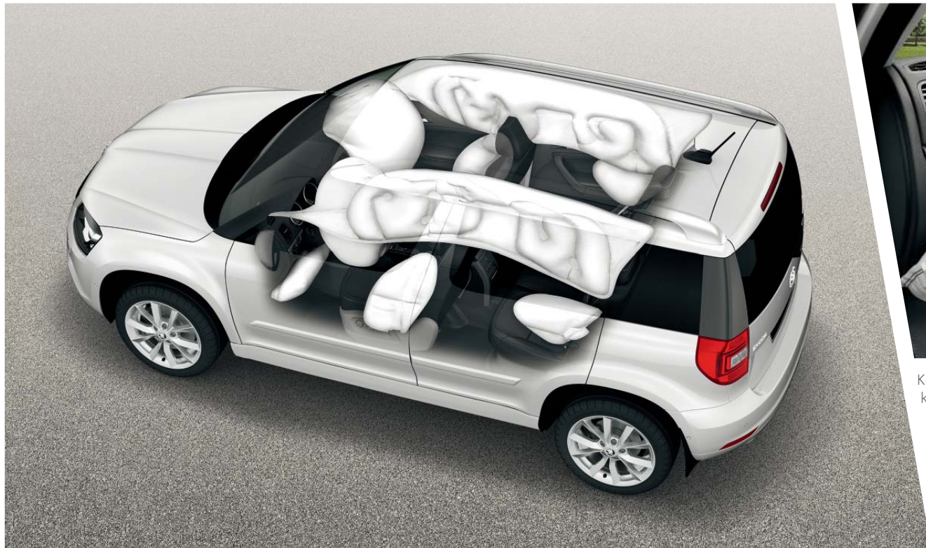
Hlavové airbagy, které vytvoří po aktivaci stěnu před bočními okny, chrání hlavy cestujících vpředu i vzadu.
