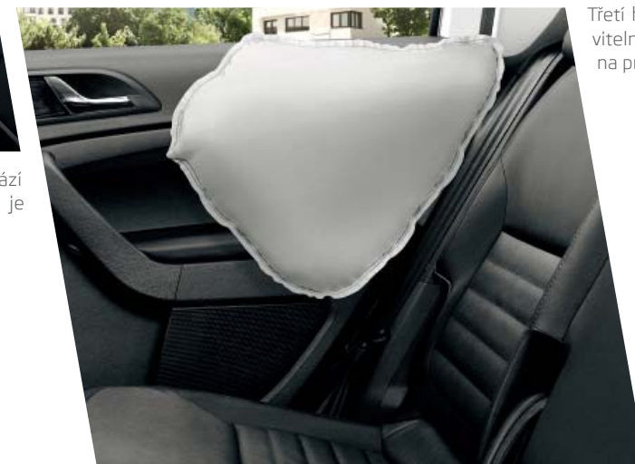
Přední a zadní boční airbagy jsou určeny k ochraně pánve a hrudníku pasažérů vpředu a na zadních krajních sedadlech.
