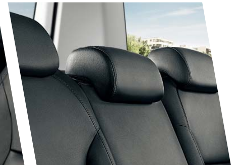
Třetí hlavová opěrka vzadu, výškově nastavitelná, zvyšuje bezpečnost cestujícího na prostředním sedadle.
